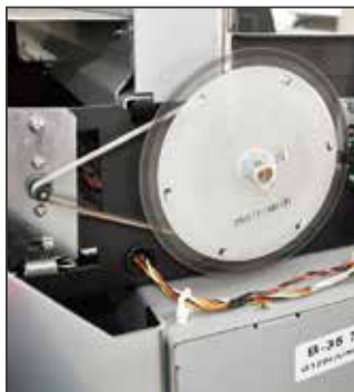
5. El encoder circular mejora el ajuste de avance de material. Reduce el error y mejora la calidad de impresión.
